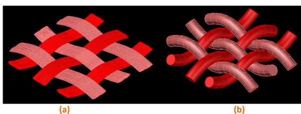
Fig. 3 : Différence d'aspect d'un tissu a) constitué de mèches, b) constitué de mono fil
