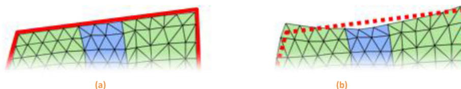
Fig. 32 : [GEN02] : déplacement « macro » imposé sur le bord de la cellule micro a) exacte, b) en moyenne
